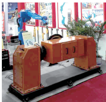
机器人离线编程智能堆焊机器人系统 (应用于粮油机械行业)
