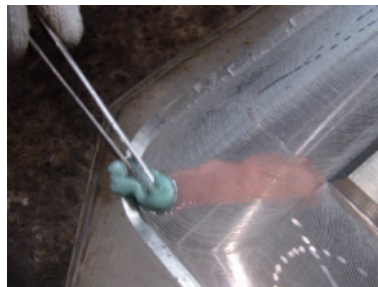
图5 使用硫酸铜溶液检测机加工状况
