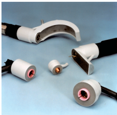
图2 具有四层保护结构的PWI焊枪
