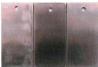
图6 均匀腐蚀试验后试样宏观形貌
