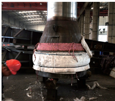
(a) 加热设备及石棉板铺设
