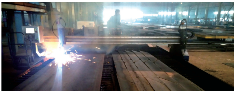
图3 中心立柱零件切割
