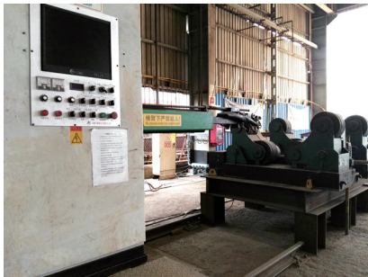
图1 小管径纵缝埋弧焊工作站
