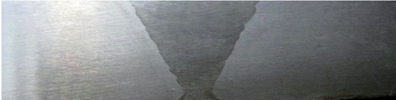
图2 焊接接头宏观照片 表6 拉伸试验性能
