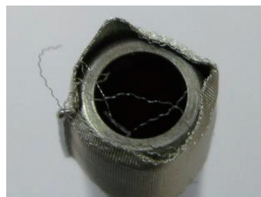
图7 装配过程中压坏压毛的过滤网
