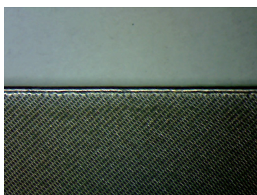
(a) 过滤网焊后焊缝外观
