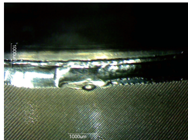
(a) 滤网与骨架B和C焊缝表面未焊上
