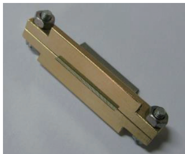
图5 安装A焊缝过滤网的工装1
