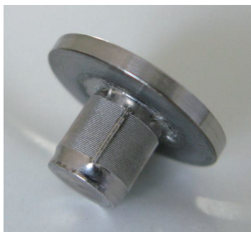
图9 焊接起弧和收弧位置
