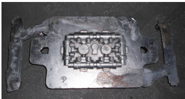
图13 浇注现场背面
