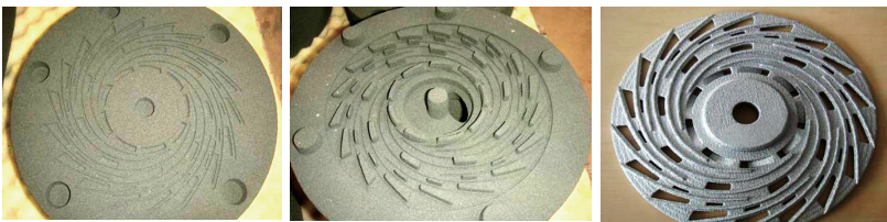
(a) 打印的砂型（半模） (b) 打印的砂型（半模） (c) 浇注生成的铸件
