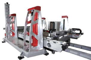
图5 Voxeljet 4000大型三维打印系统
