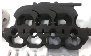
图6 3D打印砂芯
