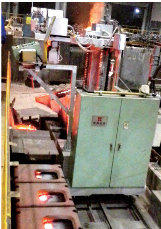
图2 某公司重心驱动浇注机现场
