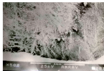
图10 裂纹源区形貌
