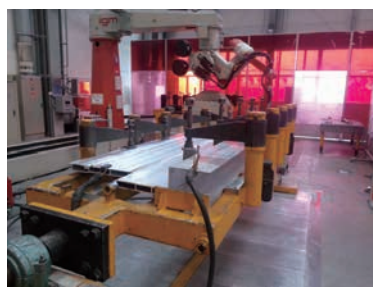
图6 动车组端墙墙板自动焊接
