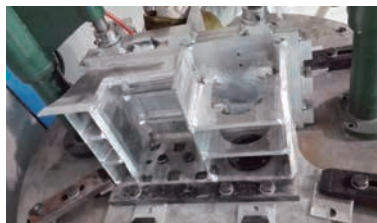
图4 抗蛇行减震器座焊接装夹
