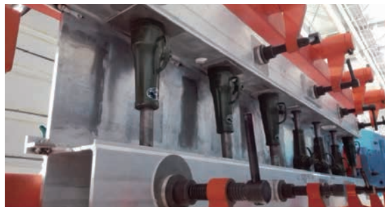
图2 枕梁筋板焊接
