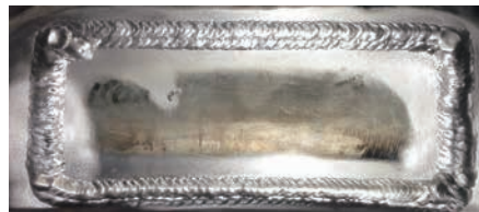
图7 焊后焊缝外观
