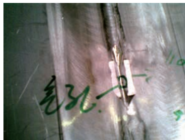
图3 焊缝内部气孔
