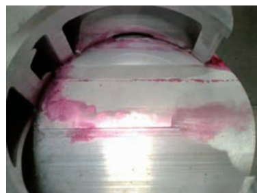
图2 去除垫板后渗透检测
