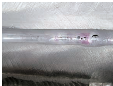
图3 焊缝内部气孔
