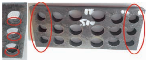
图5 板厚10mm切割圆孔效果
