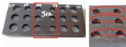
图6 板厚12mm切割圆孔效果
