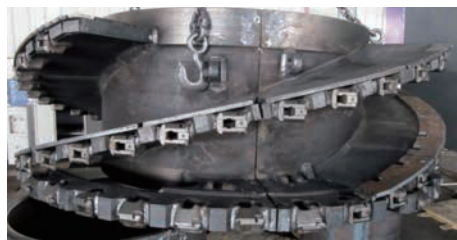
图8 改进后的螺旋滚筒耐磨块组装
