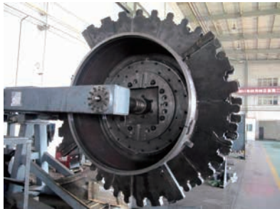
图4 改进后成形的端盘与筒体的组装对接焊
