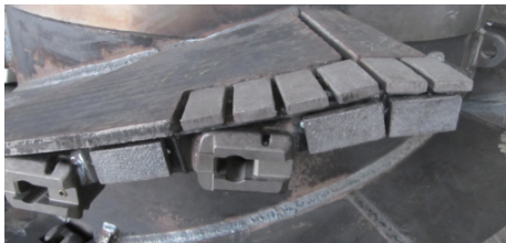
图7 改进后的螺旋滚筒叶片辅板
