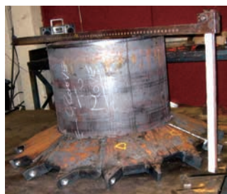
图5 端盘、螺旋叶片与筒体的组装
