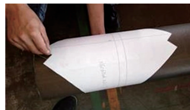
图14 复杂形状的腹管纸质样板
