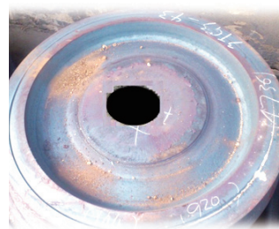
图4 轮箍外圈沟槽实物
