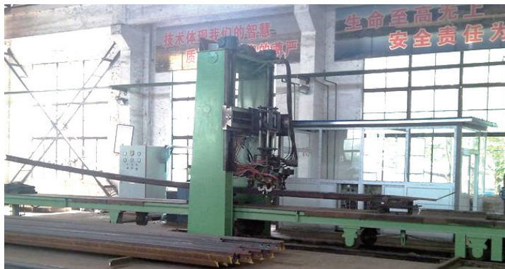
图2 研发的钢轨中频感应淬火机床
