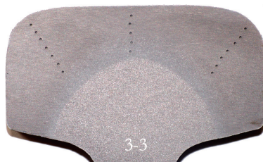
图3 钢轨中频感应淬火后的硬化层
