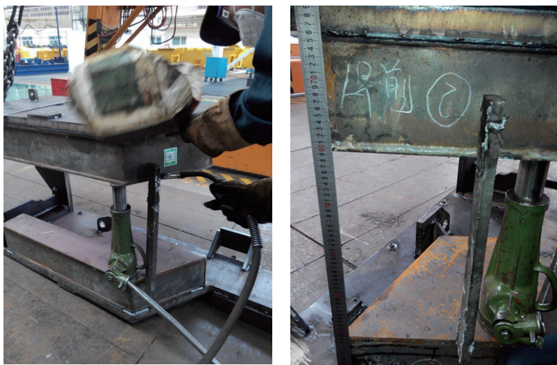
图2 主机架传统防焊接变形措施
