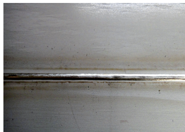
图5 纵缝背面保护装置下的焊缝
