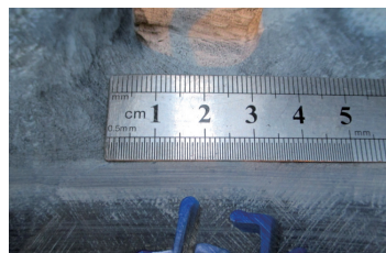
(b) 左2 (裂纹长度9 mm)
