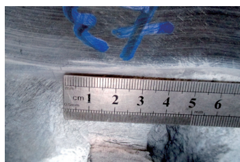
(d) 右3 (裂纹长度19 mm)
