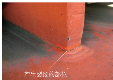
图1 裂纹产生的部位
