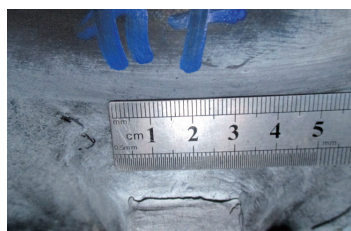
(e) 右4 (裂纹长度30 mm)
