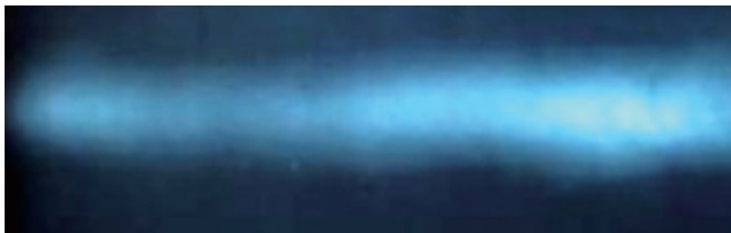
图9 试板4焊缝射线底片影像
