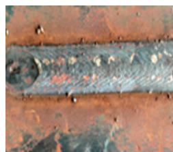
图7 试板4焊缝外观
