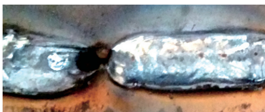
图4 试板2焊缝外观
