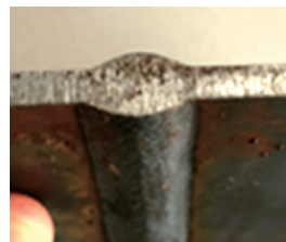
图8 试板4焊缝截面
