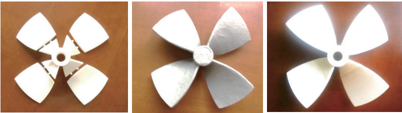
图4 搅拌釜砂铸模样及毛坯铸件
