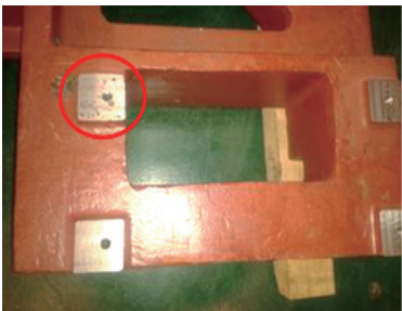
图5 床身电动机座安装脐子缺陷
