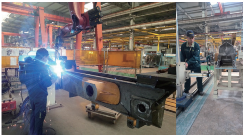
图8 履带梁机器人焊接
