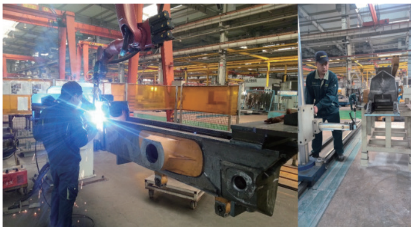
图8 履带梁机器人焊接
