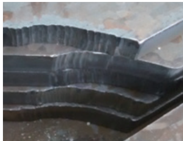
图10 短线段导致的锯齿缺陷
