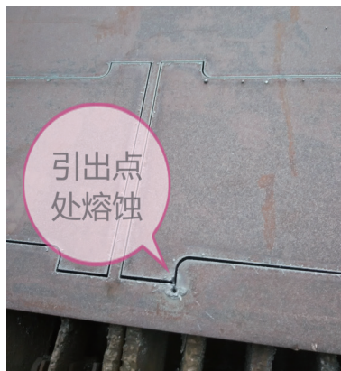
图5 引出点熔蚀图
