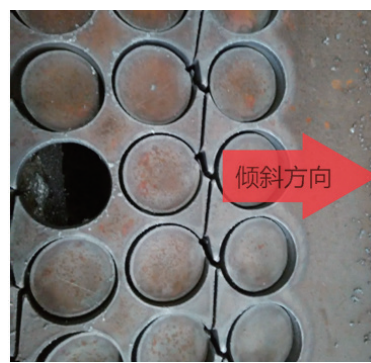
图12 零件倾斜偏向切割路径
