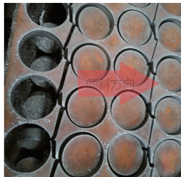
图11 零件倾斜偏离切割路径
