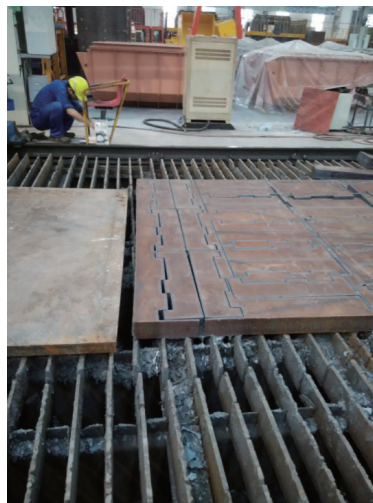
图1 钢板受热变形
