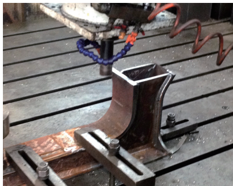
图4 支腿坡口加工
