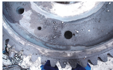
图1 齿轮腹板裂纹宏观形貌
