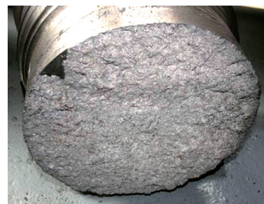
图1 高铬钢轧辊浇口端辊颈宏观断口形貌
