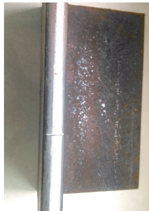
图5 宽度为1mm深度为2mm的人工对比试件
