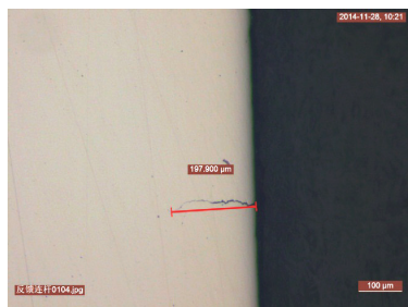
图3 零件横截面金相 (100 \times )
