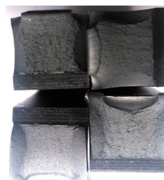
图2 冲击吸收能量偏低试样断口
