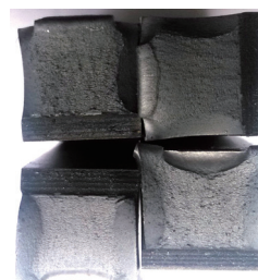
图2 冲击吸收能量偏低试样断口
