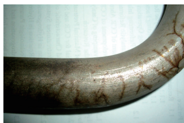
图4 100%应力下316L(未固溶)弯管裂纹萌生和扩展
