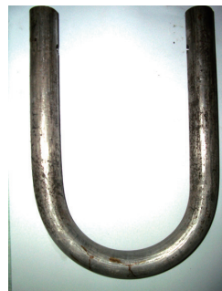
图5 40%应力下SAF2205(未固溶)弯管失效状态
