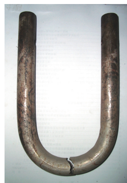
图3 60%应力下304(未固溶)弯管失效状态
