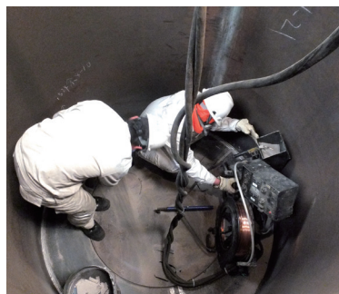
图4 埋弧半自动小车焊接
