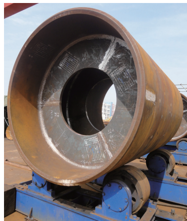
图2 导管加强环实物
