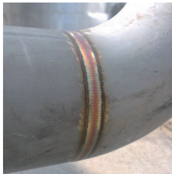
图9 盖面焊缝效果
