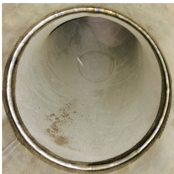
图8 打底层内部焊缝效果
