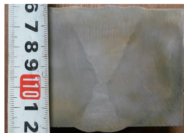
图4 焊缝断面宏观
