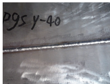
图6 焊缝打底背面成形
