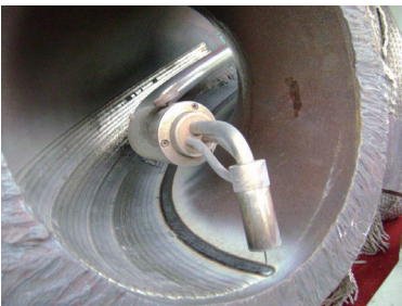
图15 弯管堆焊过程中及完工状态
