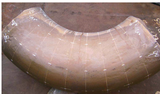
图10 热压成形并经性能热处理的弯管
