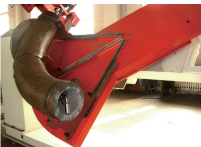
图13 90° 启焊位置 堆焊完成1/4
