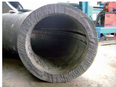
图15 弯管堆焊过程中及完工状态
