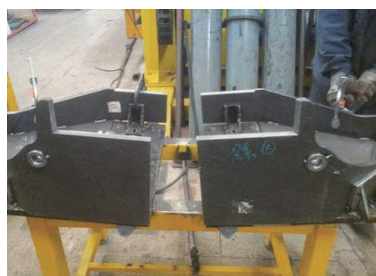
图5 牵引支座板组对工装
