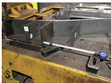
图7 图号354002652外侧距离空气簧中心尺寸
