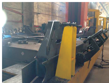
图3 焊接过程反变形样板
