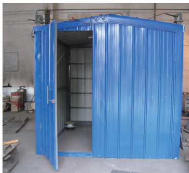
(a) 焊接作业室
