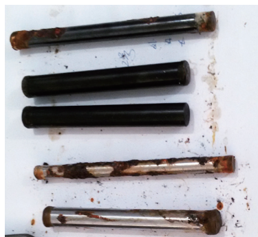
图3 镀铬与氮碳共渗盐浴复合处理试样盐雾试验后
