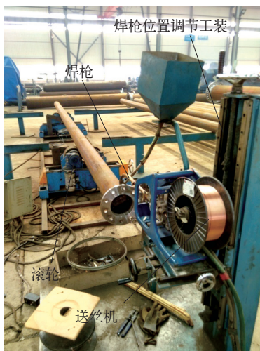
(a)焊接设备结构
